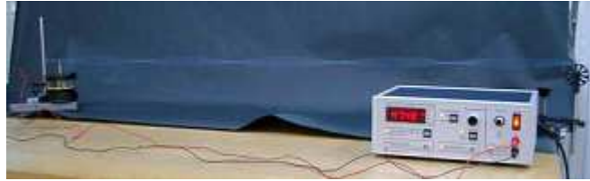
Figura 2 - Fotografía del montaje experimental. Se aprecia el generador de ondas y una onda estacionaria.
