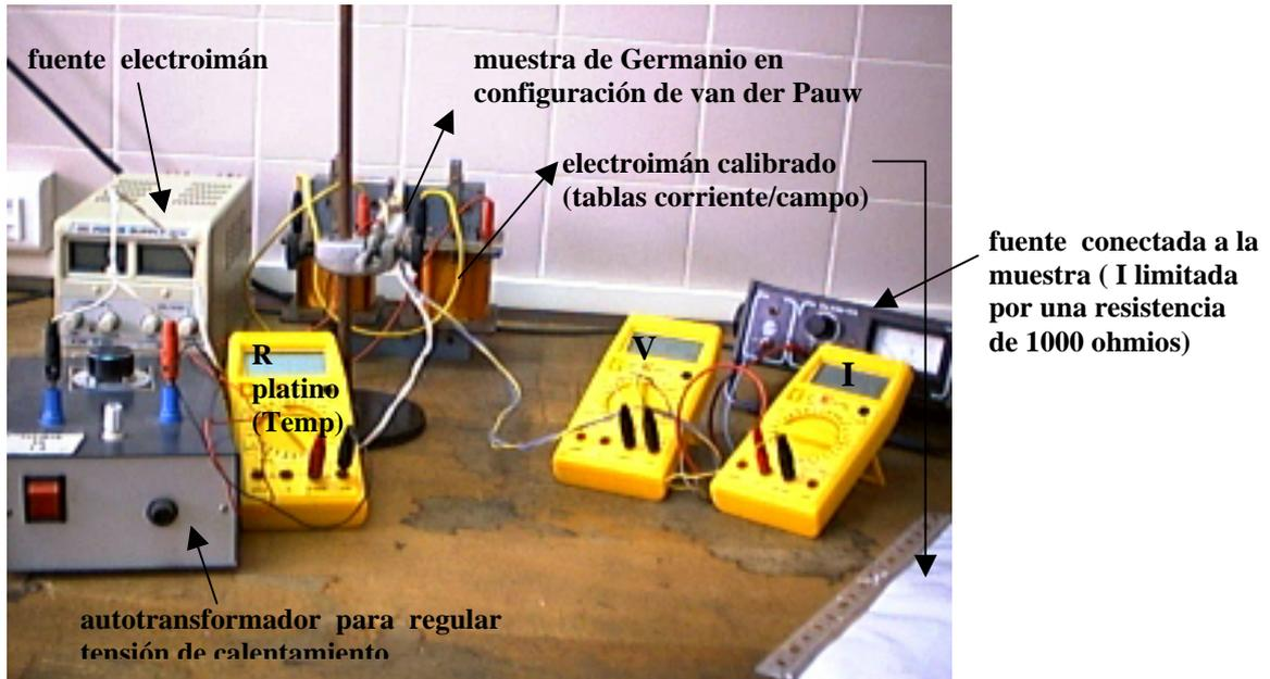
La muestra cuadrada de **Germanio** (de **0.5 mm** de grosor) está montada en un sistema de calentamiento formado por una resistencia de soldador, un portamuestras y una resistencia de platino embutida en el portamuestras como sensor de temperatura. Del sistema salen ocho hilos: dos de la resistencia de calentamiento (negros), dos de la resistencia de platino (negro y rojo, a conectar en un polímetro) y cuatro de la muestra (**A: azul; B: gris; C: amarillo y D: marrón**):
